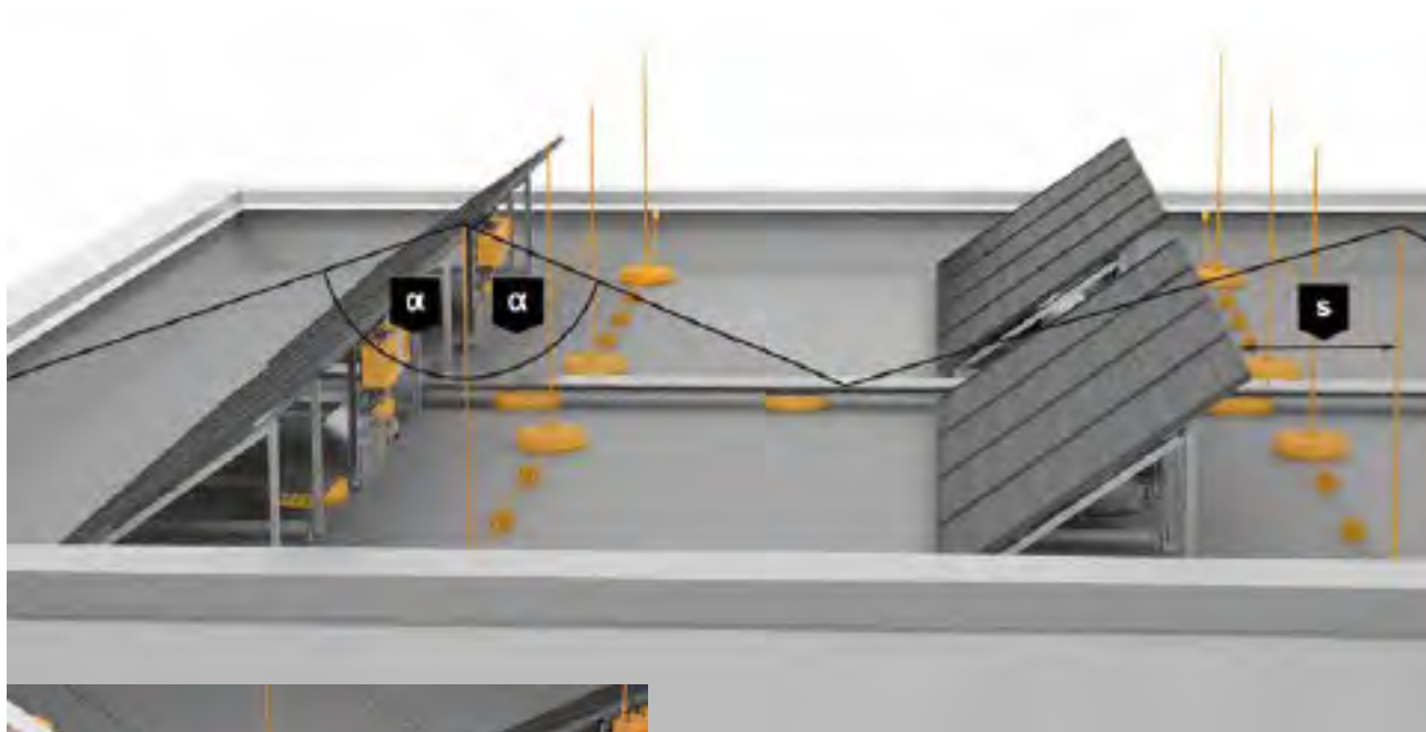
Protecție externă împotriva descărcărilor electrice pentru sistemele de acoperiș în unghi.
